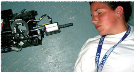
Robot menggunakan sensor kapnografi untuk mengukur napas korban dari kejauhan
